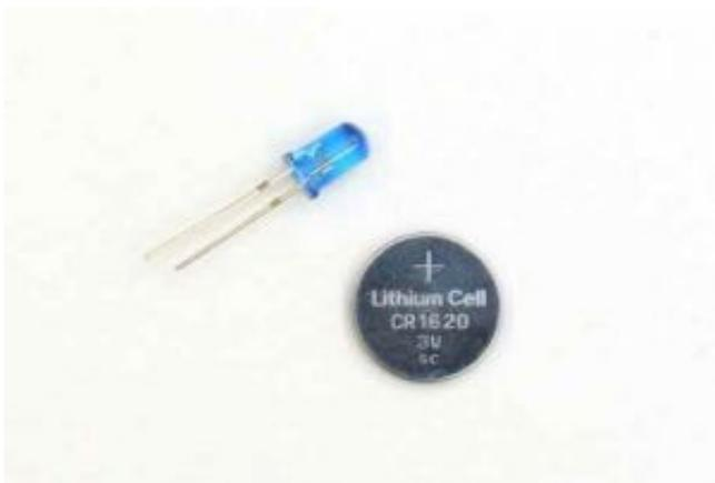
2. Die LED hat zwei verschieden lange Beinchen. Das lange Beinchen ist der Pluspol (Anode), das kurze Beinchen der Minuspol (Kathode). Auch die Batterie ist gepolt und hat eine Plus- und eine Minusseite. Die Plusseite der Batterie erkennt man an dem Pluszeichen darauf.
